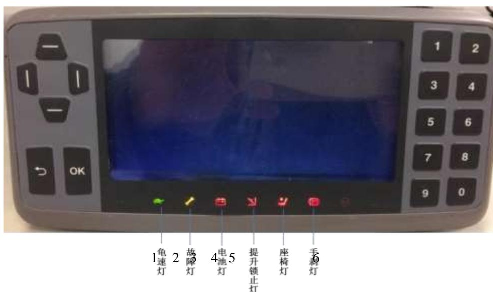
1. Indicador para velocidade de tartaruga 2. Indicador de falha 3. Indicador da bateria
