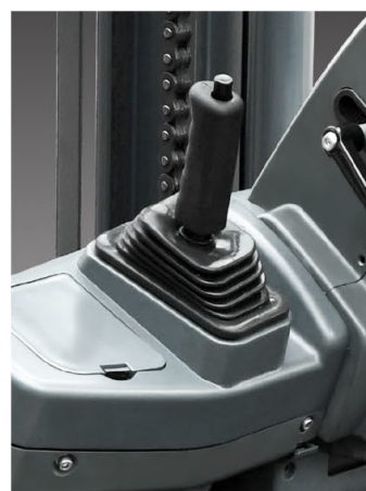
O novo tipo de freio manual reduz a força operacional em 17%
