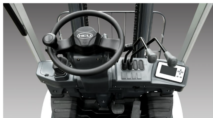
Haste de válvula de controle da empilhadeira de combustão interna, mais adequada aos hábitos do condutor
