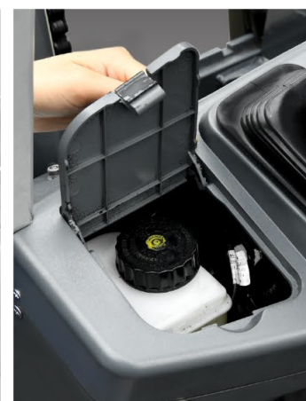
Líquido para freios acessível, fácil de verificar e reabastecer
