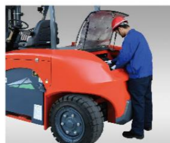
Altura adequada de operação do gabinete de controle elétrico
