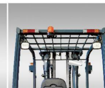
Sistema de iluminação em LED
